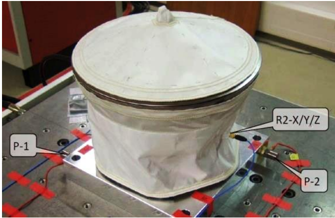
Fig. 19: Net: Vibration EVT Testing.
